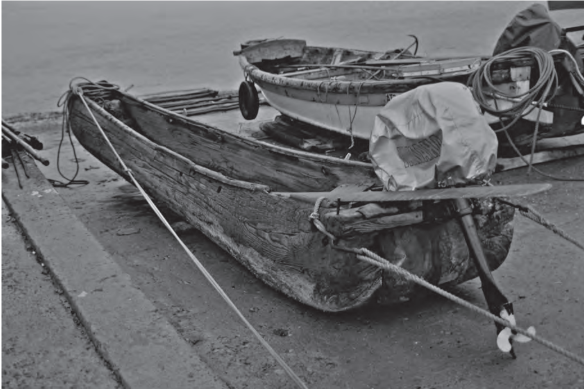
写真1 男鹿のエグリブネ 単材の刳船が最後に残ったのは、男鹿半島戸賀湾と種子島である。本文の「中の領域」の北と南の端に残ったのには何か理由があるのかもしれない。この当時、戸賀湾には20隻程度が実働状態で残り、かつ新造船までであったのである（現在は一艘が現役船）。秋田杉の大木を刳り抜いた無骨な造りで、たくさんの補修跡が見られる。写真の当時はおおむねワカメ採りに使われていた。1985.12
