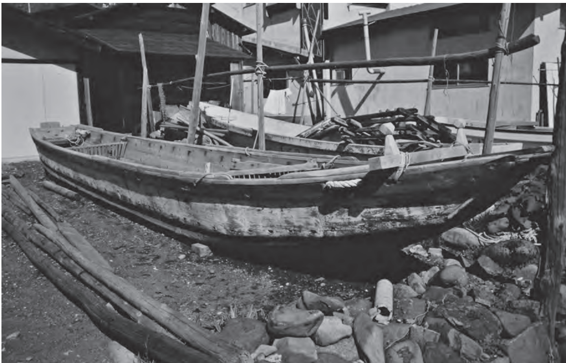
写真2 八森のマルキブネ タナ発達のムダマ造りの複材刳船の典型的な船で、大きな刳り底の上にタナ板がヨロイ張りで継がれている。そのままでは強度が不足するため写真ではよく見えないが、内側に肋骨材で補強が入れられている。秋田県八森から岩館付近に分布して、ハタハタ漁に使われた8人乗り程度の大型船である。1990.5
