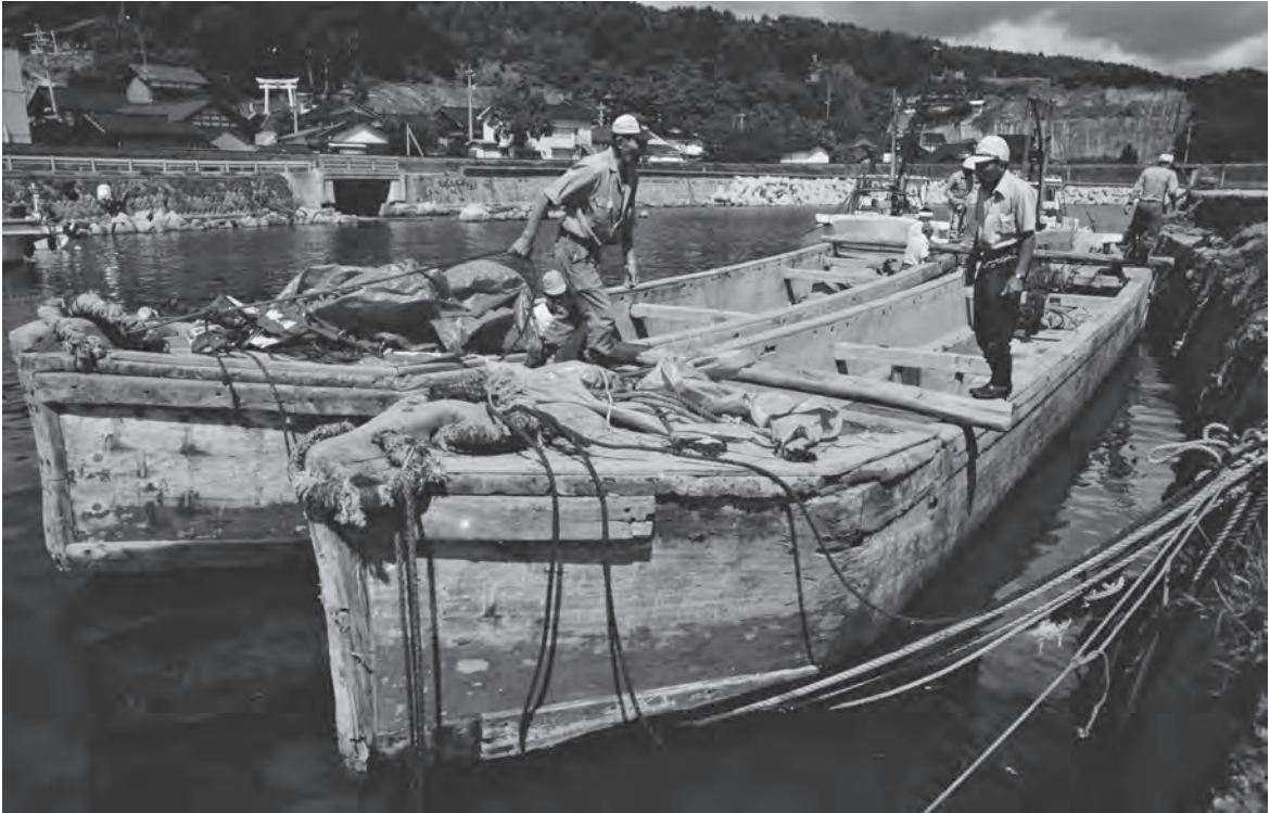
写真3 能登・波並のドブネ オモキ造りの刳船の中では大型船で、地域によって少しの構造の違いや大きさに差はあるが、富山湾から能登半島全域で網船として使われた船である。ここでは定置網を敷設するための船として残り、最後の現役ドブネとして、後に重要有形民俗文化財指定を受けて、現在は博物館に展示されている。1987.9
