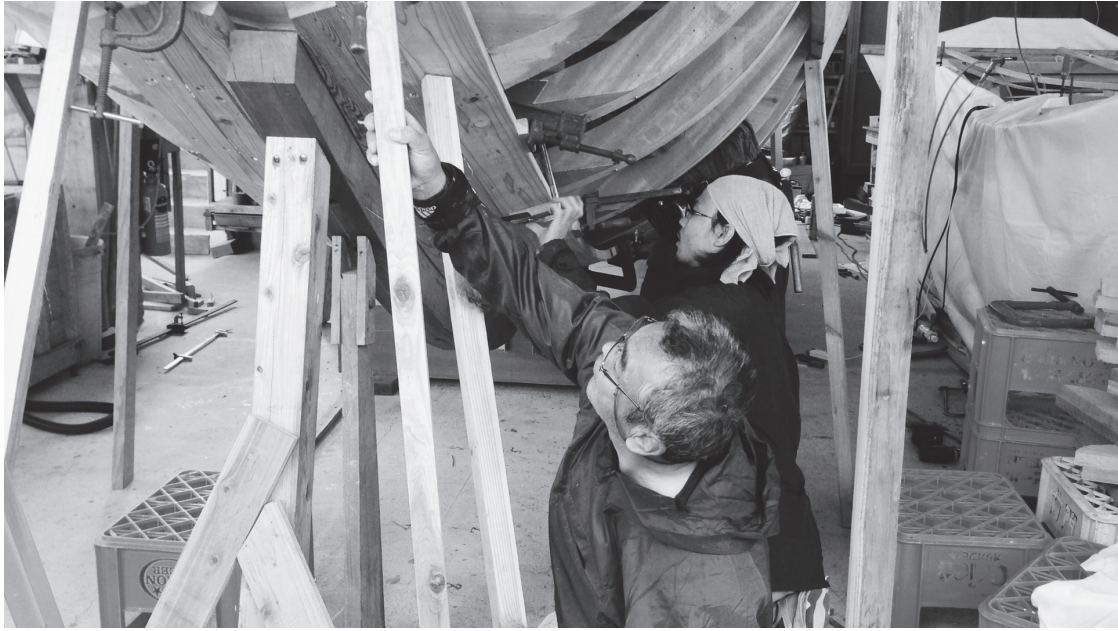
写真6 外板のひねりを調整するようす
