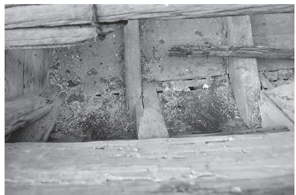
写真 43 サンパン船内、油灰が剥離し隙間が見えている (泉州海外交通史博物館)
