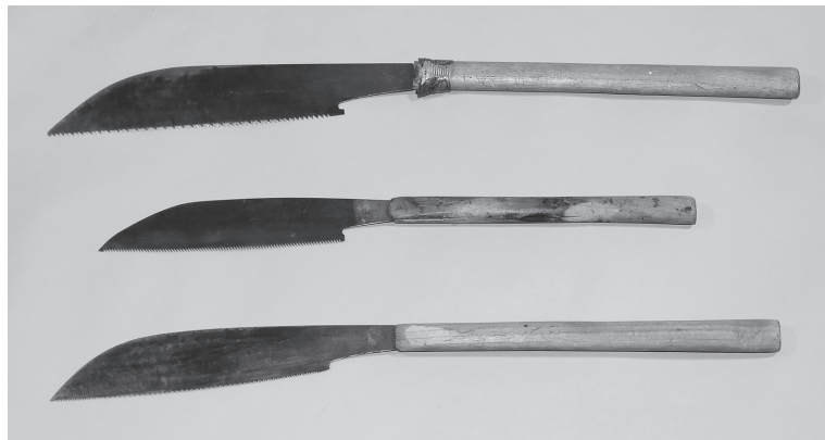
写真 10 アイバノコ (氷見市立博物館) 上から粗目のオオノコ、中目のチュウバ、仕上げ用のコブクラ
