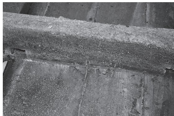
写真 51 肋根材の鋸刃痕。船底材の接合部には繊維状の充填材が見える
