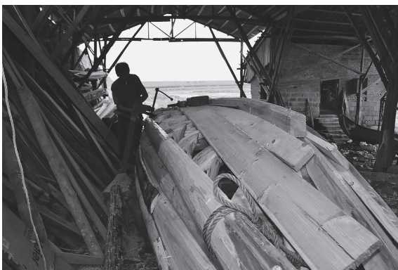
写真 38 舷側部外板材の取り付け（福州市連江県）
