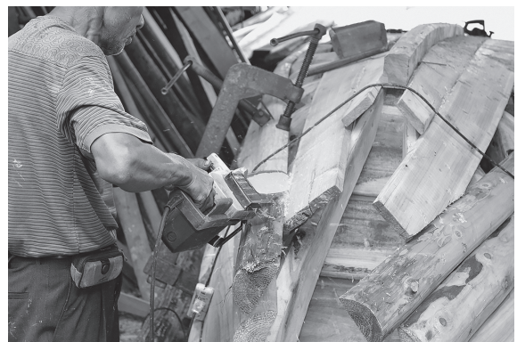
写真 39 外板材不要部分の切り落とし（福州市連江県）
