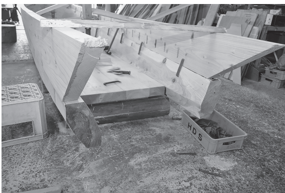
写真 48 建造中のドブネの船尾
