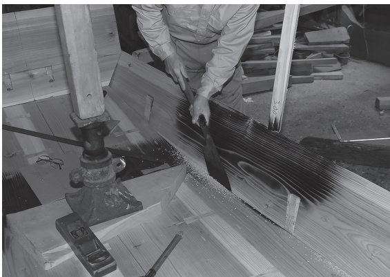
写真 11 テンマの底板と下棚のアイバスリ
