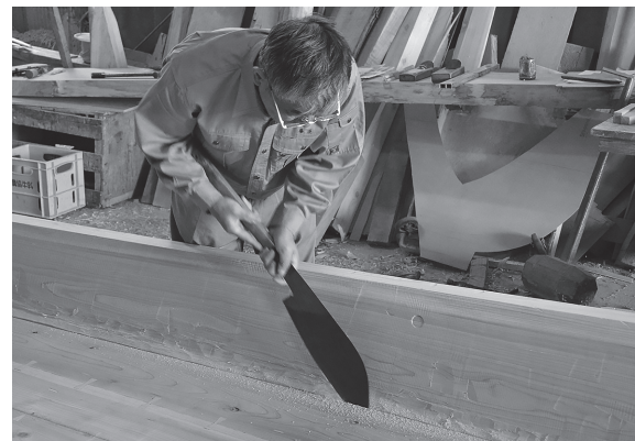
写真 12 ドブネの底板とオモキのアイバスリ
