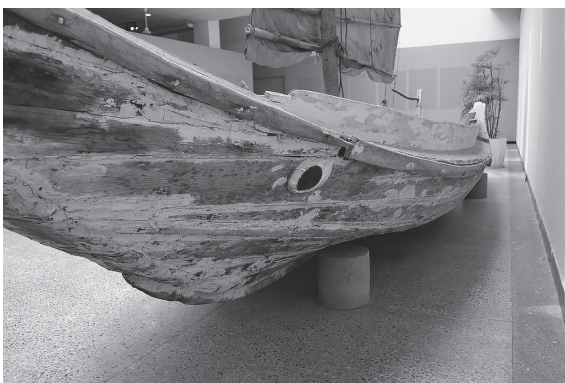
写真 42 サンパン外板接合部の油灰 (泉州海外交通史博物館)
