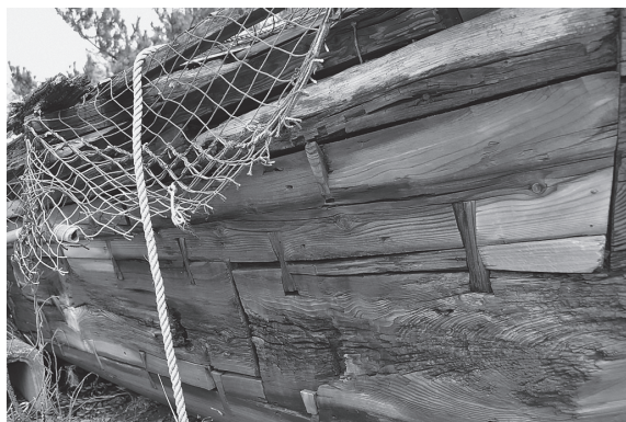
写真1 ドブネのチキリ(石川県輪島市)
