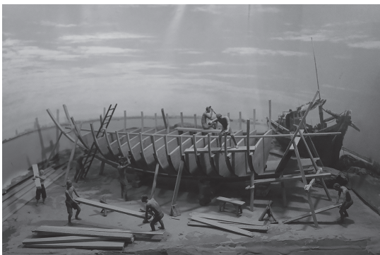
写真 30 泉州海外交通史博物館の木造船建造工程模型。多数の隔壁で構成されている
