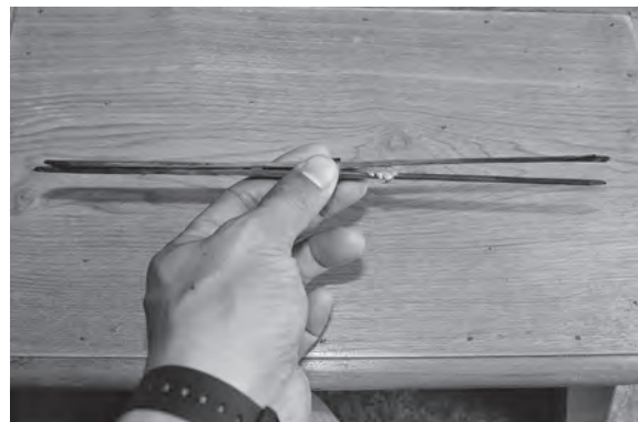
写真 43 スミサシ「箴扇 (ミシン)」は2本重ねてクチヒキにする (泉州市張国輝氏工房)
