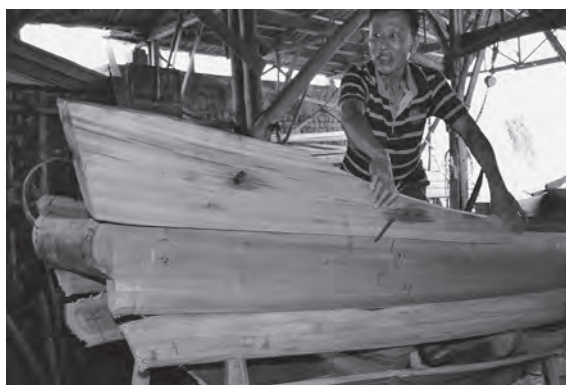
写真 67 船首反り上がり部を取り付ける
