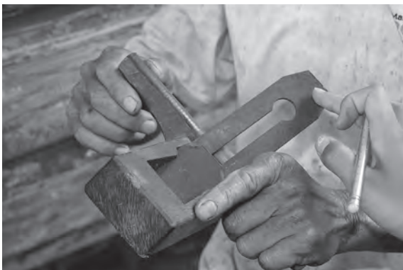
写真 50 台鉋「トゥエロウ」 (福青沃造船所)
