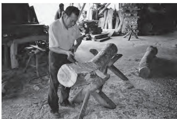
写真 54 斧で肋骨材を整形する
