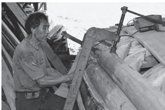
写真 72 船釘で外板を固定する
