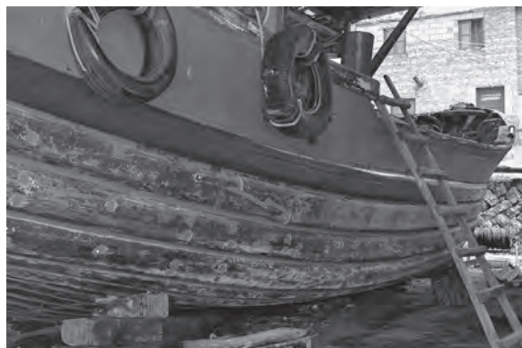
写真 20 大型漁船舷側部の「帯魚接」（福青沃造船所）
