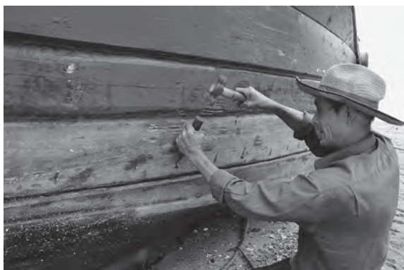
写真 28 漁船の修理作業 (福青沃造船所)
