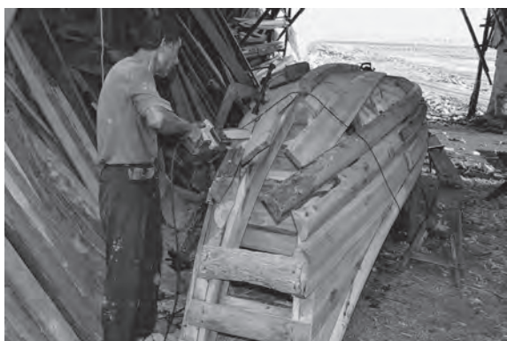
写真 74 干渉する外板材を切り落とす
