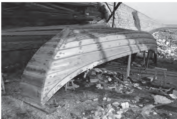
写真 76 ほぼ完成した船体に油灰を充填する
