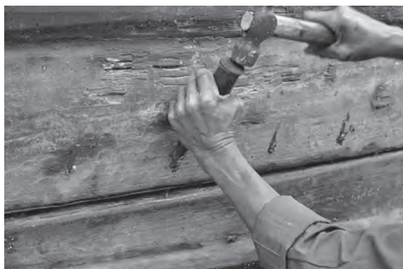
写真 29 船首側は外側から縫釘を打つ (福青沃造船所)
