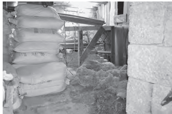
写真 33 油灰の材料となる石灰の袋と麻 (福青沃造船所)
