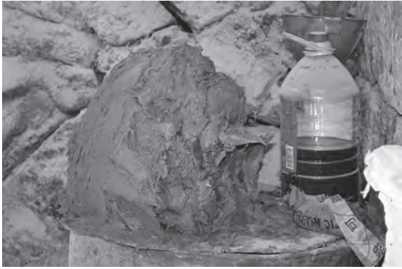
写真 34 練り上がった油灰 (福青沃造船所)
