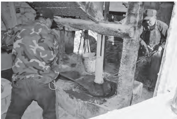
写真 32 電動の臼で油灰を捏ねる (福青沃造船所)
