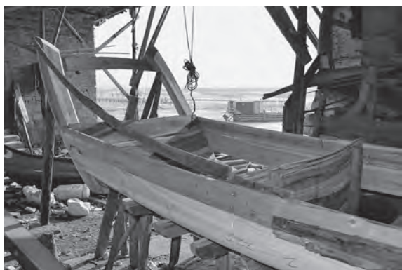
写真 64 船尾反り上がり部の型板
