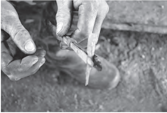
写真 44 2本重ねたスミサシに木片を挟みクチヒキとして使う (福青沃造船所)
