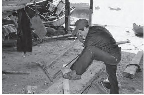
写真 45 小型の枠鋸で角材を切る (福青沃造船所)
