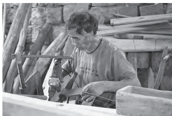
写真 71 電動ドリルで釘の下穴をあける
