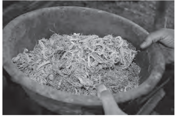
写真 35 油灰に混ぜる竹の繊維 (福青沃造船所)
