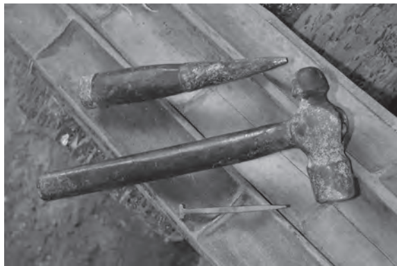
写真 25 釘締め (上) と金槌 (下) (福青沃造船所)
