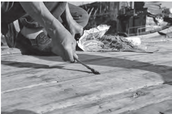
写真 38 船溜まりでの油灰充填作業 (福州市連江县)
