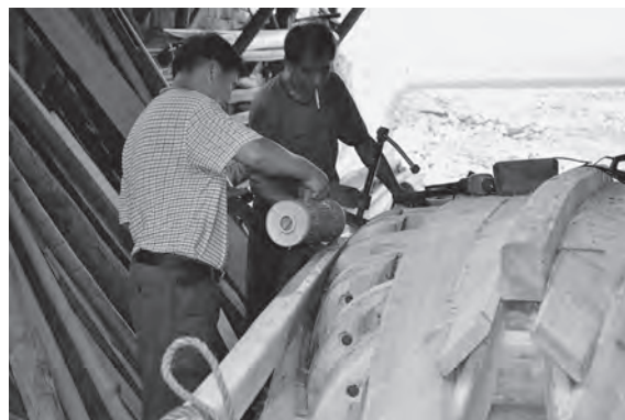
写真 69 ポットのお湯で外板材を曲げる
