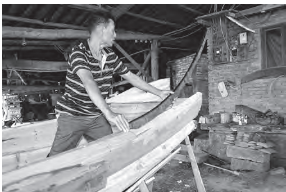
写真 66 船首反り上がり部の型板
