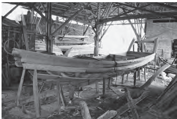
写真 60 外板材を順々に接合していく
