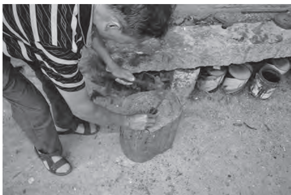
写真 26 縫釘を金槌で打って反りを作る (福青沃造船所)
