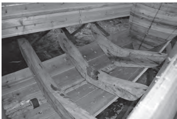
写真 58 竜骨に接合された肋根材と船底部材
