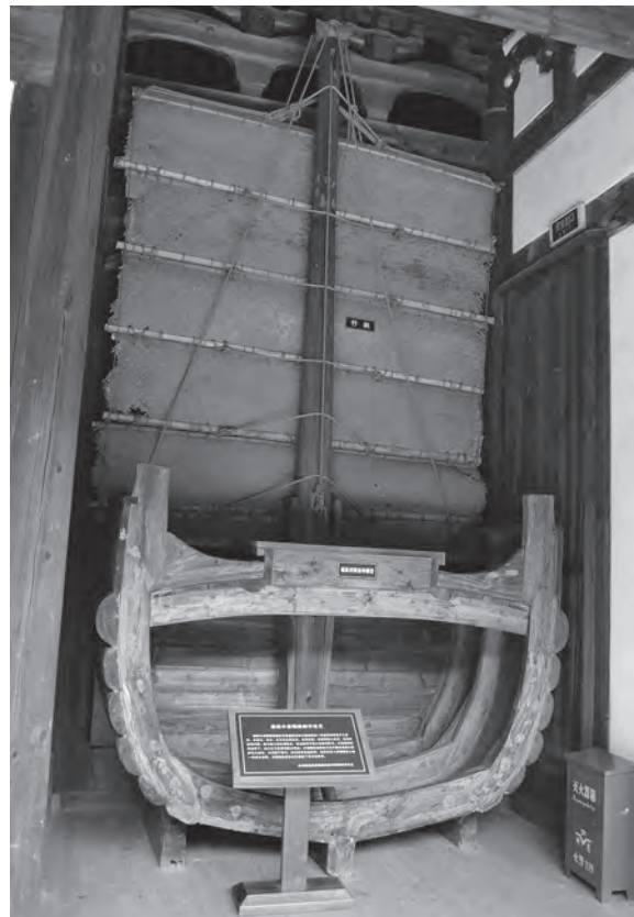
写真 23 福船断面模型 (三坊七巷福船文化館)
