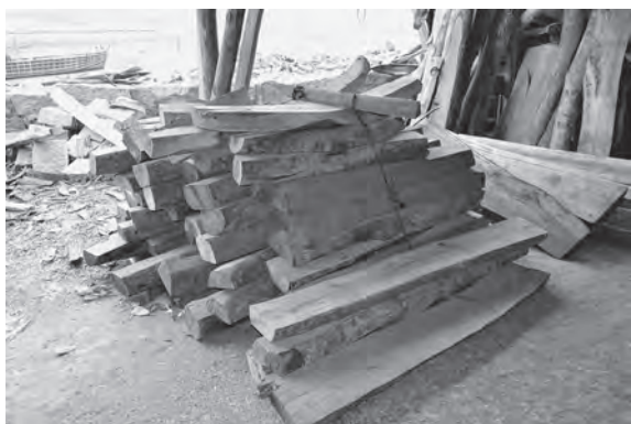
写真 56 粗木取りされた肋骨材
