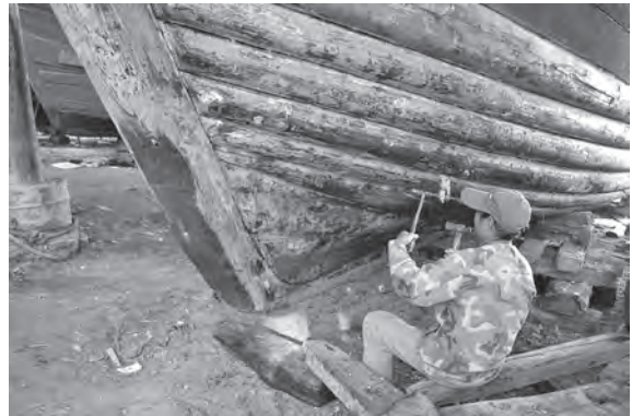
写真 37 鎌状の「パツエイ」を用いて古い油灰を掻き出す (福青沃造船所)
