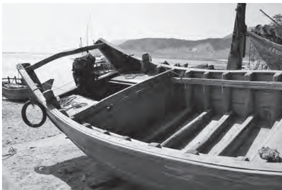
写真 15 「舢舨」船尾と肋骨材（福青沃造船所）
