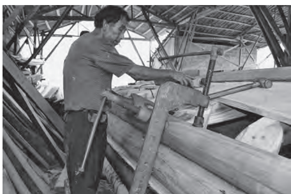
写真 70 外板材を2つの万力で締め付ける
