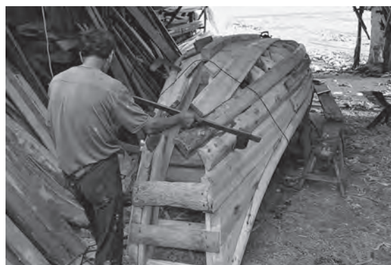
写真 75 万力で外板材を締め付ける
