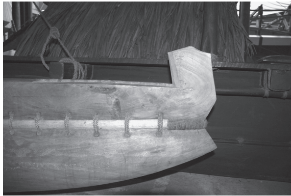
写真2 船体構造における縫合の様子 (バヌアツ・フツナ島のシングル・アウトリガー・カヌーの 船尾部 オークランド海事博物館蔵)
