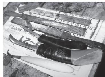
写真 19 特徴的な先曲りナイフ。 鉄ヤスリで刃を研ぐ
