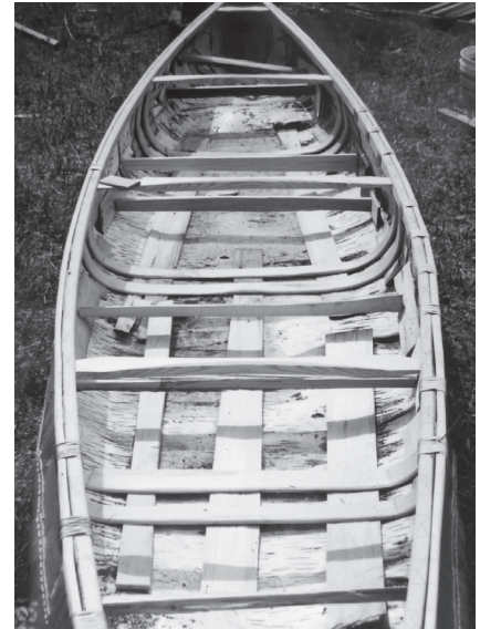
写真 42 舟型を整えながら床材を敷き入れる
