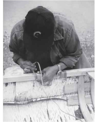
写真 41 木根紐にてガンネルと樹皮を縫合
