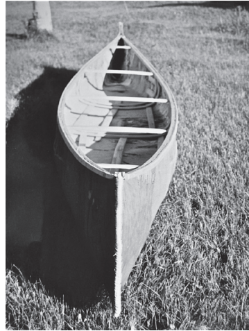
写真 40 ガンネルとビームを装備
