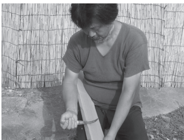
写真31 腿の上に材を置いて手前にナイフを引く
