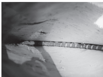
写真 39 内部から見た舟首、舟尾部分の補強
