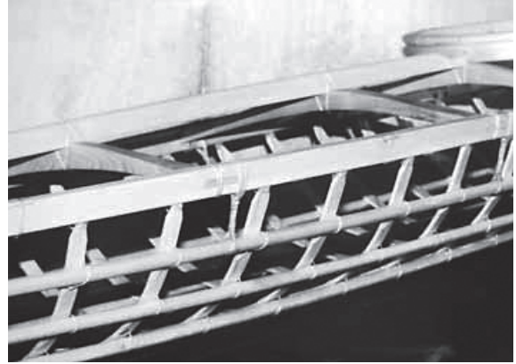
写真4 船腹部の構造とデッキ・ビーム 出典：[大矢・洲澤 2013：13]
