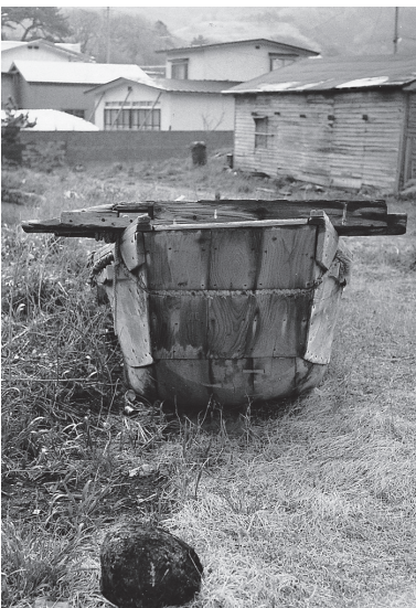
写真 1B 秋田県北浦のハタハタ船。割った船底材の側面から鎧張りに二段の舷側板を建ち上げている
