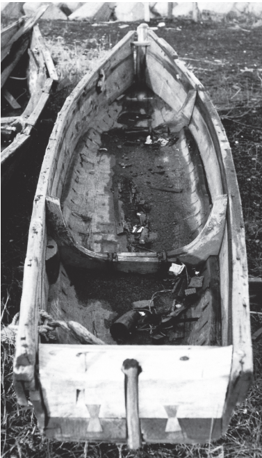
写真 1A 秋田県八森の南方船と北方船の技術が混じり合った混淆船。戸立てにチキリが入る
