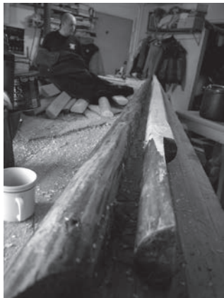
写真75、76 シブウ、アクとキールの接合部のスカーフ継ぎ加工。キールに接合されたシブウ
