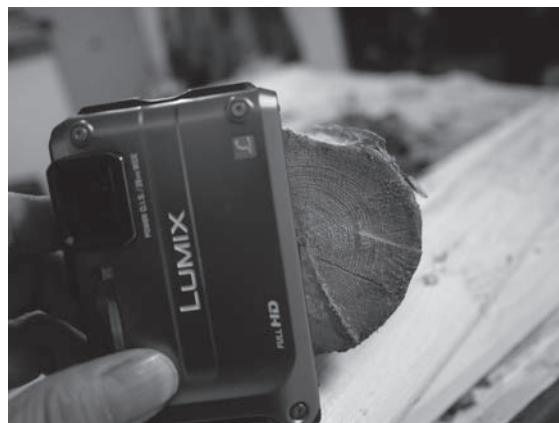
写真57 今回使う唐檜の平均直径は10cm程度である。写真の材は直径6cmほどで年輪は50年前後であった
