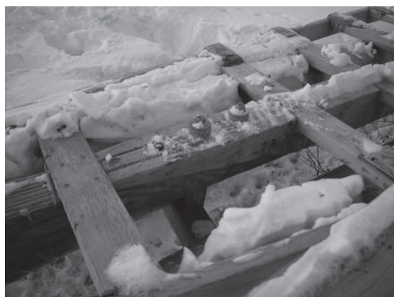
写真80 キールのスカーフ継ぎ。接着剤とボルトで固定されている。昨今造られるウミアックは、概ねこのような工法が用いられている
