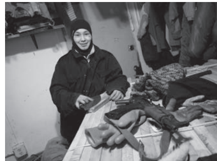
写真55 ウルを研ぐAgnes。包丁のように前後に押し引いたりして研ぐのではなく、手首を支点に刃先を振り子のように動かし、砥石の上を滑らせて研ぐ
