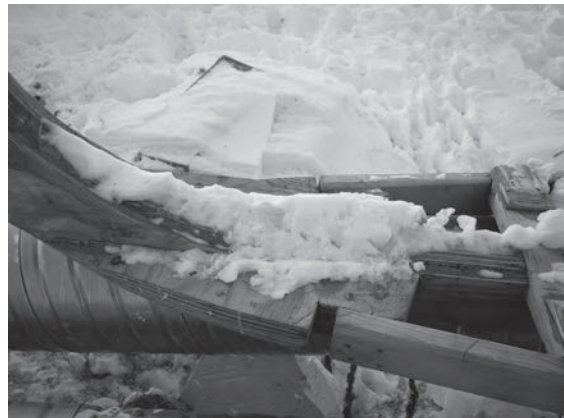
写真78 シブウのチェーン、キールの接合部。チェーンとシブウは釘で接合している
