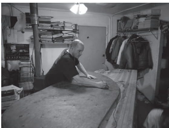
写真73、74 耐水合板から部材を切り出し、材の厚みが足りないので、補助材をボンドで接着している
