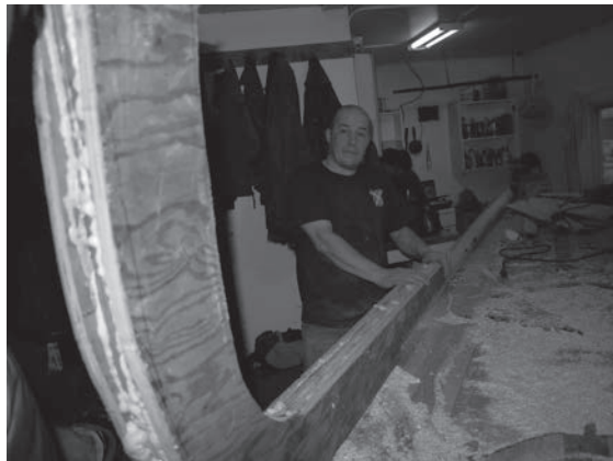
写真75、76 シブウ、アクとキールの接合部のスカーフ継ぎ加工。キールに接合されたシブウ
