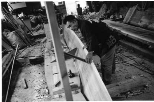
側板を平板張りにする
