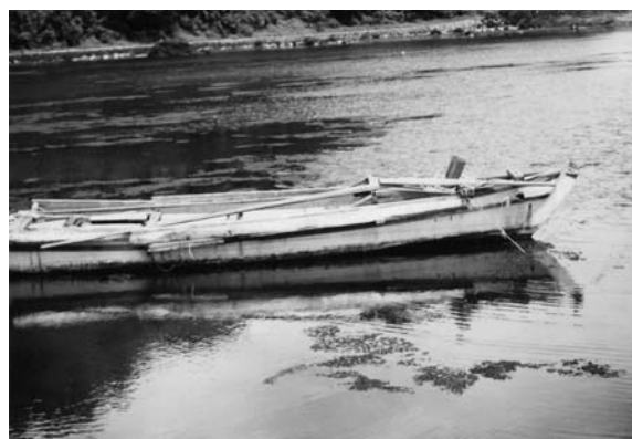
サンバ(オジョリのラグーン)で 平板張りの技術は日本の船大工の得意とするところだった
