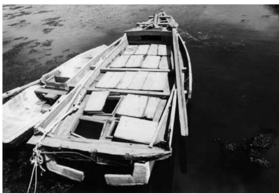
サンバ(オジョリのラグーン)で 平板張りの技術は日本の船大工の得意とするところだった
