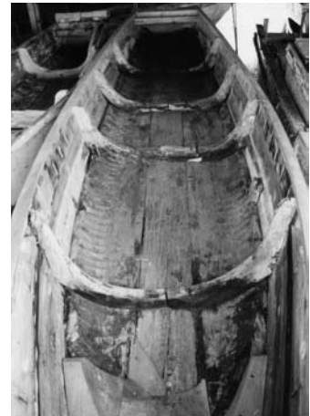
陸奥湾ホッチ船 舷側板を鎧張り (Clinker)で二段上げている
