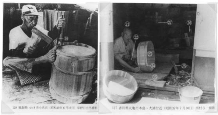
図56 上、5景の写真は、フランス中部のシャヴィニヨール・アン・サンセルの樽作りの職人 すべて立位で作業 (Bernard Henry Des métiers et des hommes an village , Paris, Seuil, 1975)。これに対して日本の桶屋は、平座位で裸足のため、足先で加工対象を固定できる。須藤功 (編) 『写真で見る日本生活図引』3、弘文堂、1988年 p.137 (左)、p.136 (右)
