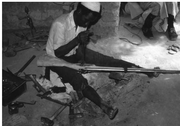
図57 自動車の廃品ステアリング・ロッドを利用して、燧石銃の銃身を作る村の鍛冶屋。裸足の平座位が、足指での対象の固定を可能にしている。西アフリカ・マリ中部のセゲーで、1991年、筆者撮影
