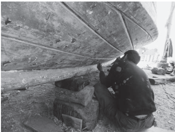
写真2 福青沃造船所における木造船の修理作業
