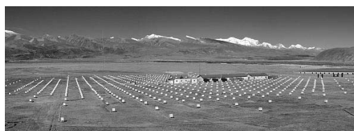
図3 羊八井国際宇宙線観測所全景。白い点状に見えるものがシンチレーション検出器からなる宇宙線空気シャワー観測装置。中心部に制御室や中性子観測装置などの建物がある。
