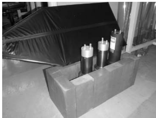
図2 製作中の雷ガンマ線検出器。上面以外を遮蔽するように3台のシンチレーション検出器を取り囲んでいる。黒い光遮蔽シートの中にはプラスチックシンチレーターの平板が入っている。
