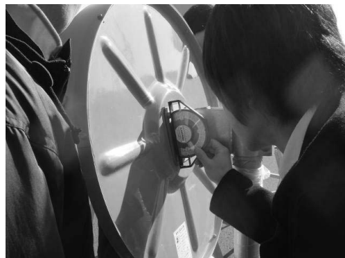
図 5 ミラー背面に傾斜計を当てて俯角を測定する
