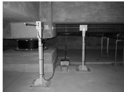
写真2 免震層の変位観測装置と地震計
