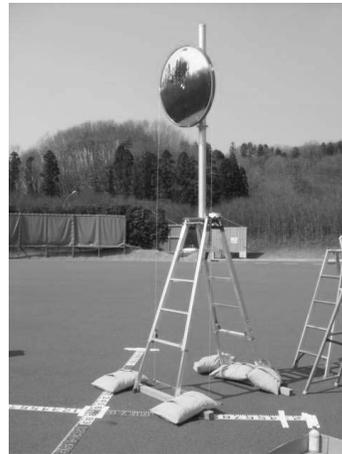
図5 水平角が調整できる実験用ミラー
