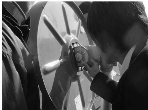
図6 ミラー背面に水準計を当てて俯角を測定する
