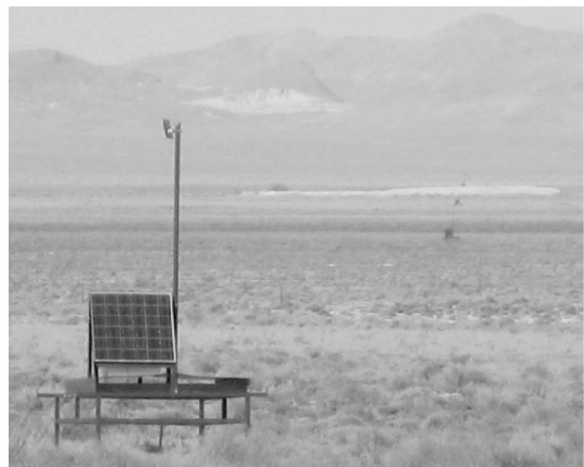
図 4: 南から北へと並ぶ地表検出器。黒く格子模様が入ったように見えるのはソーラーパネルで、シンチレーターは暗箱に入れられてテーブルの天板の位置に置かれている。検出器右側のポールに取り付けられた無線 LAN アンテナはコミュニケーションタワーの方向を向いている。
