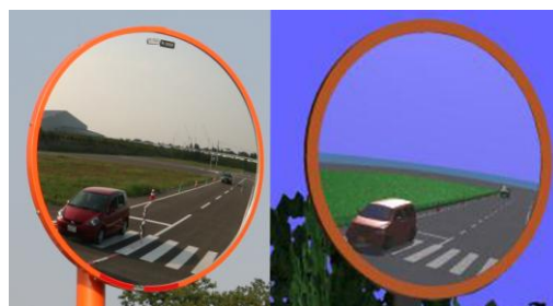
図11 3次元CGシミュレーション結果 1 左：実際、右：シミュレーション 車の位置、大きさが一致している。
