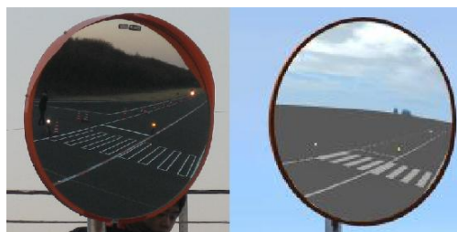
図12 3次元CGシミュレーション結果 2 カーブミラー設置検討用マーカ光源実験の再現 左：実際、右：シミュレーション 光源の位置が一致している。
