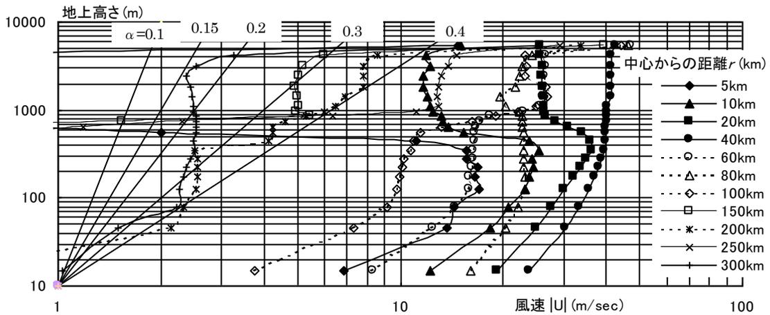
図8 T9119の風速高さ方向プロファイル(27日16時,  $R_m=84.4\text{km}$ ). (注) 直線は $U=(z/10)^\alpha$ を表す。
