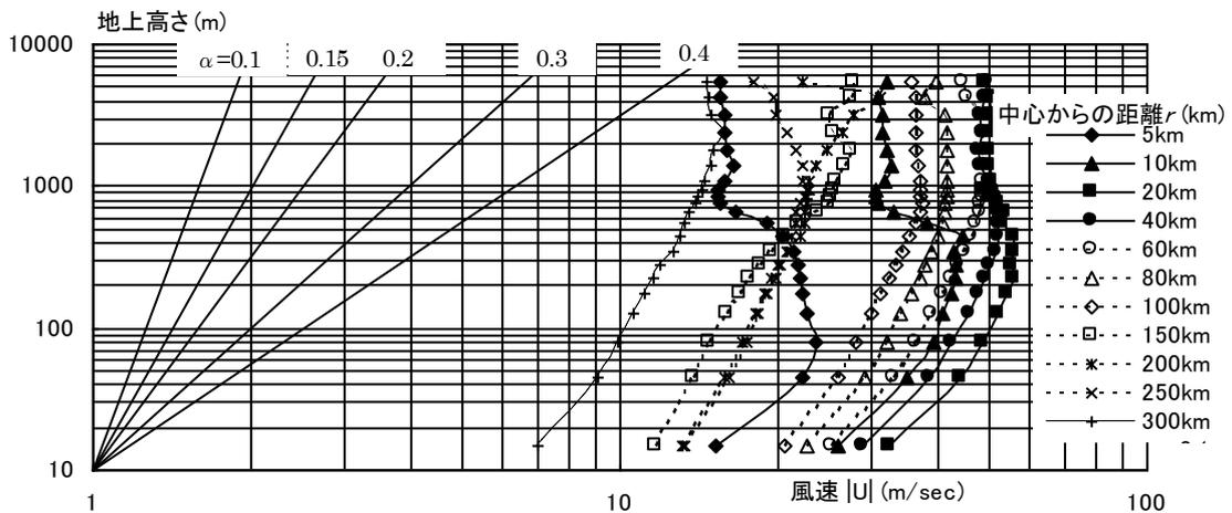
図9 T0314の風速高さ方向プロファイル(11日0時,  $R_m=30.7\text{km}$ ). (注) 直線は $U=(z/10)^\alpha$ を表す。
