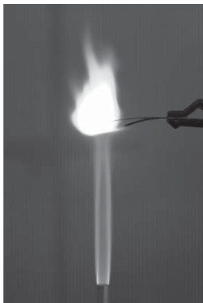
図5 ガスバーナーによる炎色反応
