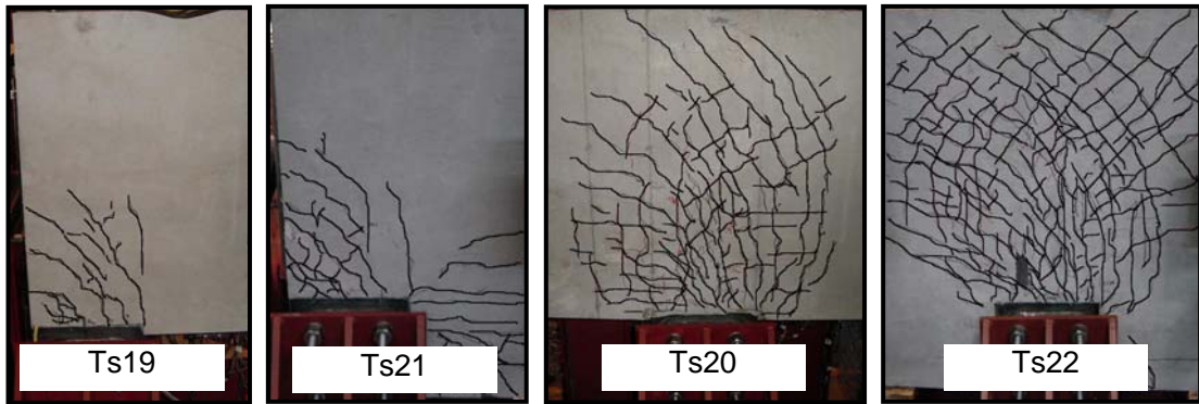
図 3.3.3.3 ひび割れ状況 (Ts II シリーズ)
