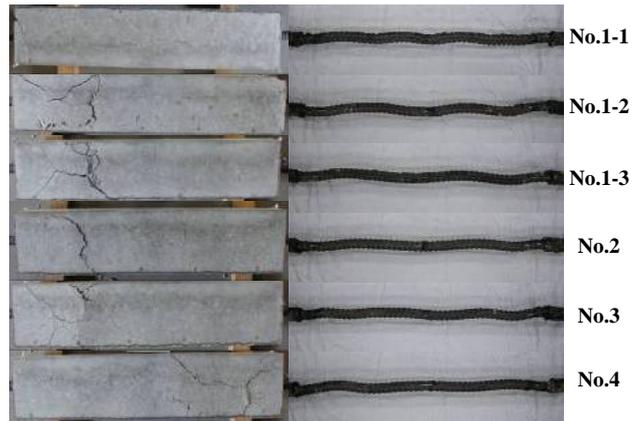
写真 1 ひび割れ・芯鉄筋の局部変形状況
