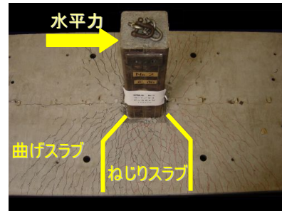
図1 耐荷機構の模式図
