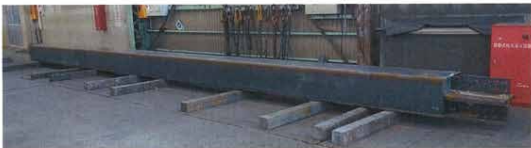
写真 7.3 モックアップ試験体
