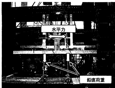
(a) Fp 試験体加力状況
