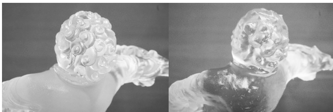
写真3 3D スキャナの違いによる精度の比較
