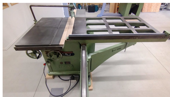
軸傾斜横切り盤
