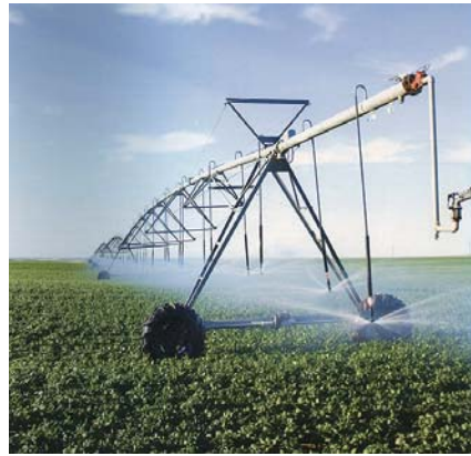
(右) センターピボットと農場。農場の中央に井戸があり、汲み上げた水は中心を軸に農場を回転するパイプを通してスプリンクラーで灌漑される。農場の半径は400mほど。
