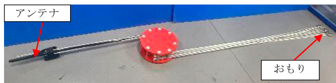
図3 製作したアンテナ展開式GPS発信機
