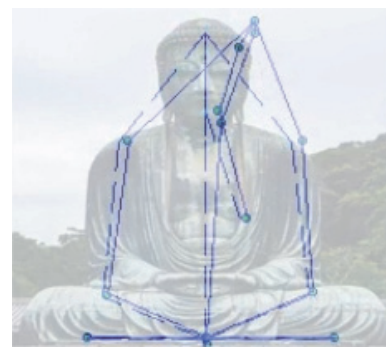
図2 鎌倉大仏の常時微動観測結果の例
