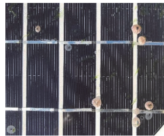
図1 ソーラパネル機能面に付着したタテジマフジツボ
