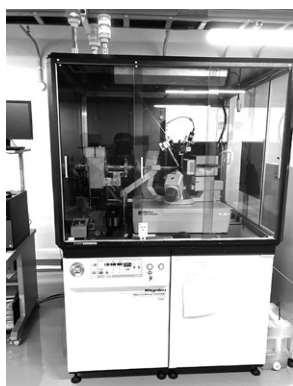
b) 研究用単結晶X線回折装置 (インターロックシステム)
