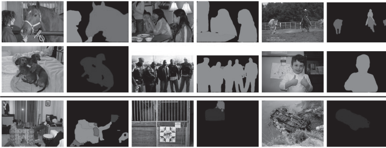
図 2-4 様々な画像をもとにセマンティックセグメンテーションを行ったイメージ (Encoder-Decoder with Atrous Separable Convolution for Semantic Image Segmentation より引用)
