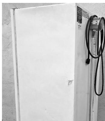
液などを入れてはならない。図3に防爆仕様冷蔵庫の背面を示した。電源コードは有機溶媒蒸気がたどり着きにくい上部から配線されている。
