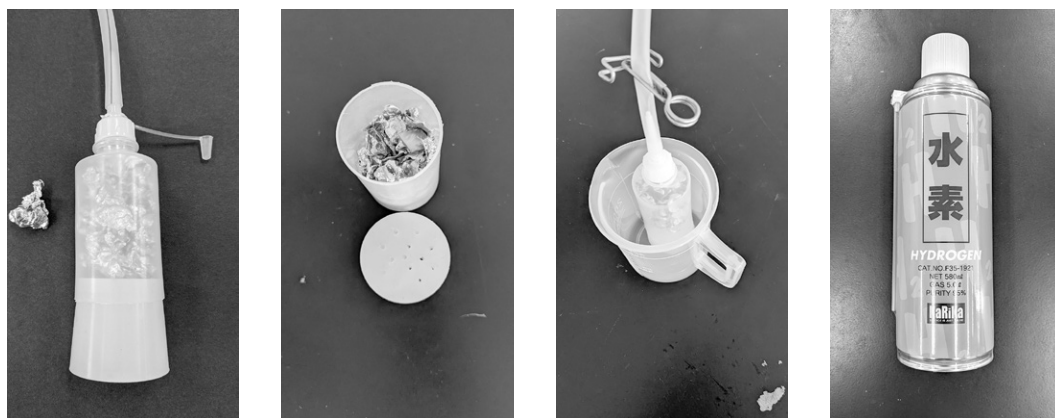
図1 水素の発生器（左 中左 中右） と 実験用スプレー缶（右）
