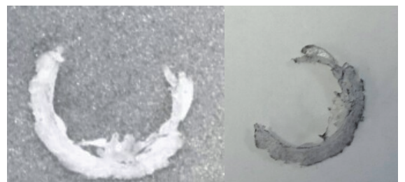
図3 11/2実施の燃焼試験（エンジン破裂）後に回収したOリング
