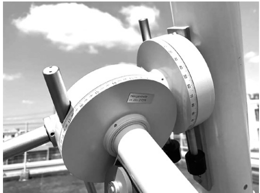
図5 天体望遠鏡の経緯度目盛環(赤経・赤緯)
