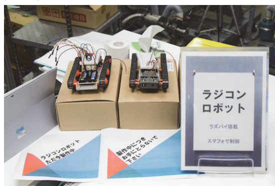
図 5 ラズベリーパイ 3 Model B によるラジコン戦車の概観図
