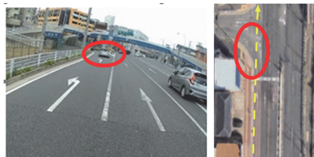
図 12 構造危険: 左折専用レーン付交差点(国1浦島丘) 直進自転車を横断者待ち一時停車車(○)が進路妨害
