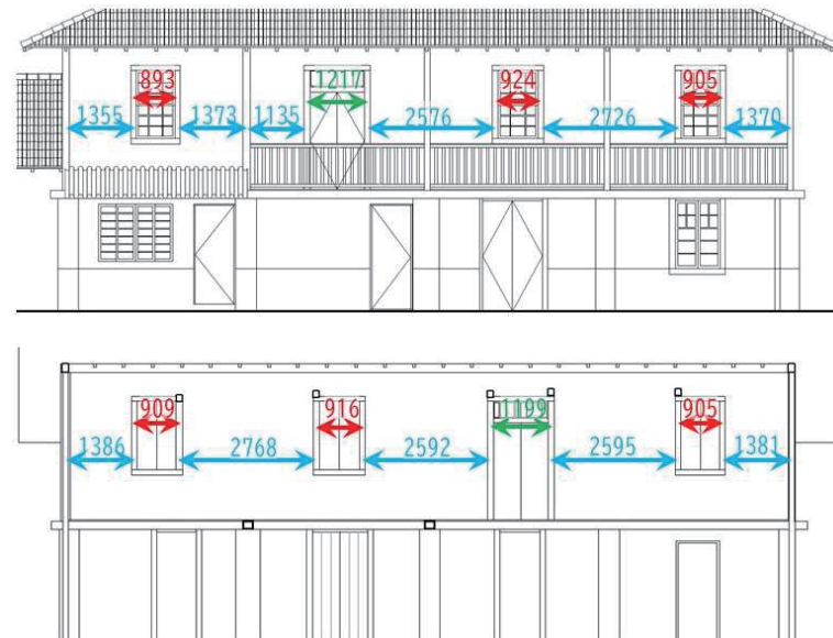
図3-18 天谷家住宅の窓幅と窓間の寸法／上：正面、下：下屋からみた背面（赤：窓、青：窓間、緑：出入口）
