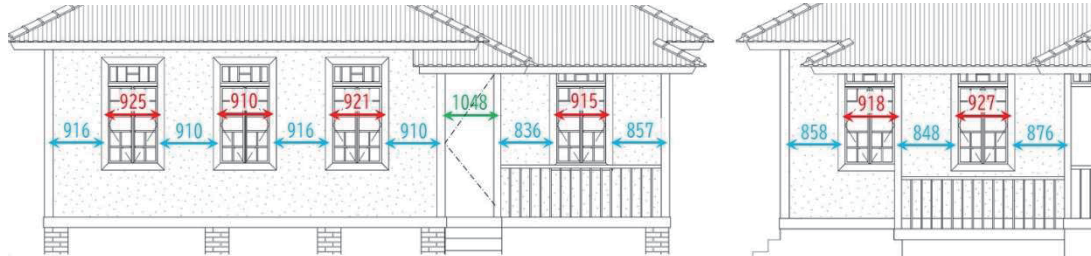
図3-17 六川家住宅の窓幅と窓間の寸法／左：西面、右：南面（赤：窓、青：窓間、緑：出入口）
