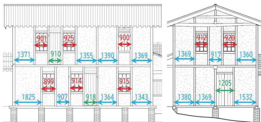
図 3-16 沖山スズ家住宅の窓幅と窓間の寸法／左：東面、右：南面（赤：窓、青：窓間、緑：出入口）
