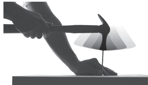
図 14 金槌の打面の面積と、力点の範囲の関係の図。
