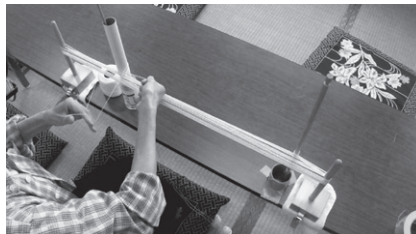
8 アヤ糸で下糸を拾って中筒に掛ける(振分綜統になる)
