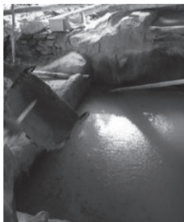
写真 13 竹籠の中の粉末石と水を攪拌する
