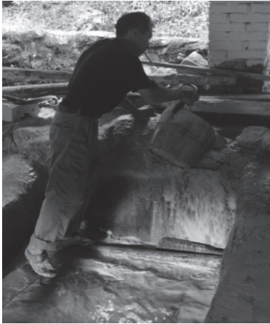
写真 15 攪拌された泥水を沈澱水路へ移動させる
