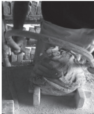
写真 22 糸切りで余分な粘土をとる
