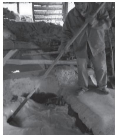
写真 14 淘汰水槽で粉末石を移動させる
