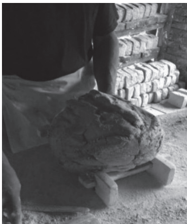
写真 24 型から成形した粘土を取り出す
