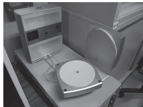
図2 3D スキャナ (NextEngine HD Pro)
