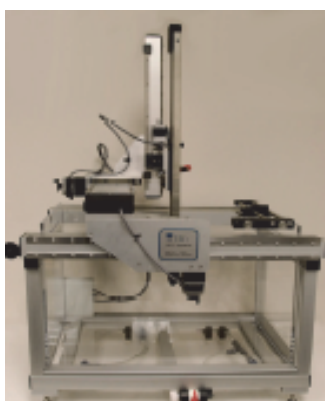
図 1 AIMS 音響強度測定システム (通称 AIMS-III : Onda 社製) の水槽、筐体、3 軸位置決め・サブシステム
