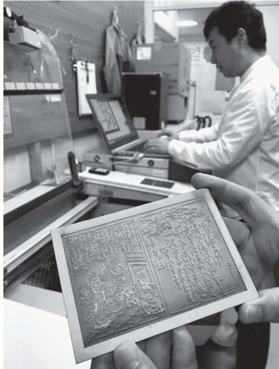
写真 5 ミニチュア版木の試作（ファブラボ平塚）
