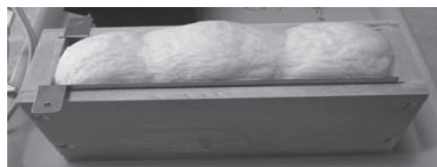
図2. 通電し膨張した生地。
