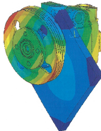
図 2.13 実験と解析によるポンプ固有モードの比較
