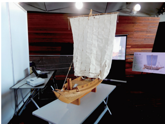
写真3 五大力船。海から川や堀割に入れるように船の深さを浅くしている
